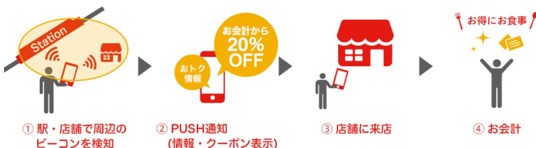
※1 Beaconとは、Bluetooth Low Energy (BLE) を利用した新技術です。2013年にiOS7に標準搭載されたことで、O2O施策への利用などで注目を集めています。今回の取り組みで利用するGimbalビーコンより発信される電波は時変式で、ログは第三者に分からないように暗号化されているため、安全に通信を行うことができます。
